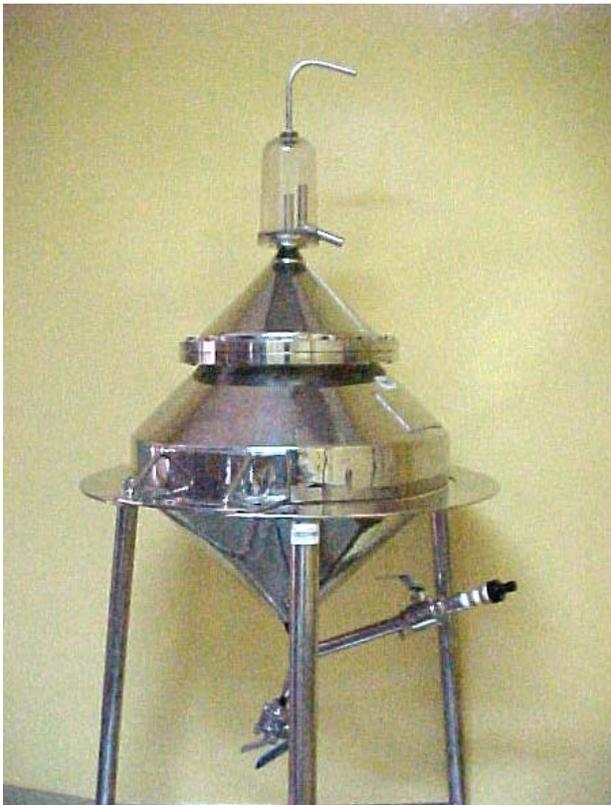
**Fig. 1** Patrón nacional de volumen; empleado como patrón de transferencia en la intercomparación de medición de volumen a 50 L
