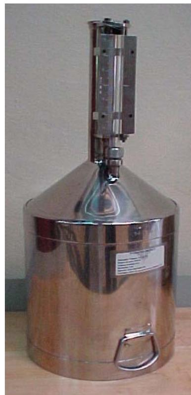
**Fig. 3** Patrón de transferencia empleado en la intercomparación de medición de volumen a 20 L.
